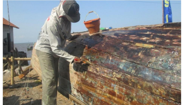
Gambar 4. Pelapisan serat fiberglass pada lambung kapal
