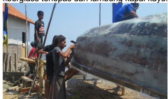
Gambar 5. Pemakuan lapisan fiberglass pada lambung kapal
